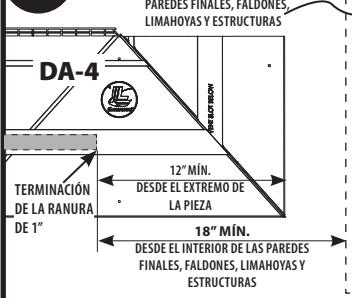
Termine todas las ranuras de ventilación a 18" de: • El interior de las paredes finales en los techos a dos aguas. • Todos los faldones y limahoyas. • Cualquier estructura o chimenea que penetre el techo.
