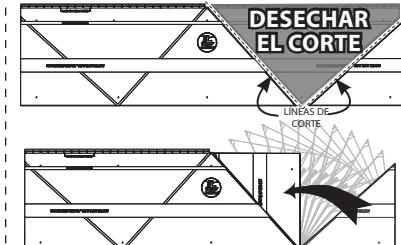
La terminación cónica del modelo DA-4 permite tener un extremo cónico más definido para que las tejas se combinen de una manera más estética en el perfil del techo.
