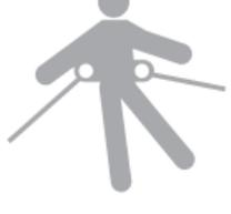
**Posicionamiento para el trabajo:** los HitchClip® pueden usarse en aplicaciones de posicionamiento para el trabajo. Los sistemas de posicionamiento para el trabajo permiten que un trabajador tenga soporte mientras está en suspensión y que funcione libremente con ambas manos. La estructura debe soportar cargas aplicadas en las direcciones permitidas por el sistema de por lo menos 3,000 lb. La caída libre máxima permisible es de 2 pies. Anillos D aplicables: Lateral, hombro.
